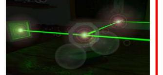
Macht man den rechten Spiegel etwas durchsichtig, so verlässt ein Teil der so durch **Selbstorganisation** entstandenen Laserwelle die Quarzrinne. Dieses Laserlicht bildet nun einen **geordneten Wellenzug** mit bis zu  $10^5$  km Länge, also einer großen Linienschärfe. Er hat fast konstante Amplitude.
