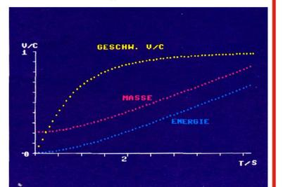
Elektron wird mit konstanter Kraft beschleunigt;  $v$  nähert sich  $c=3 \cdot 10^8$  m s $^{-1}$ , Masse  $m_e$  und Energie  $W$  nehmen zu.
