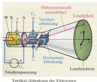
Vertikal-Ablenkung der Elektronen
