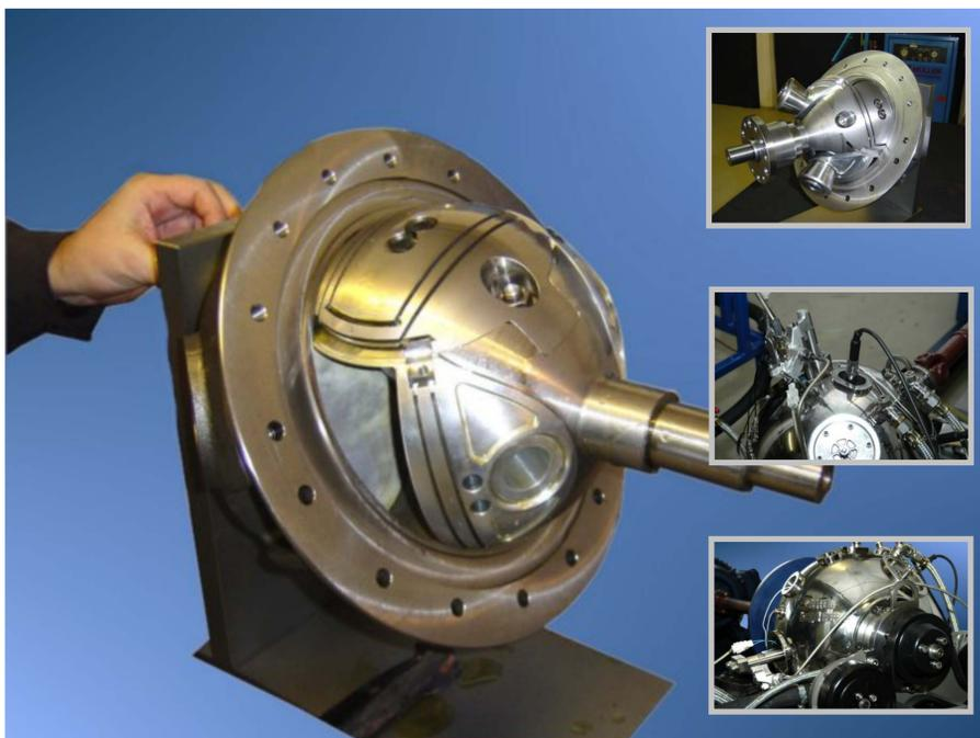
Der Prototyp weist in beiden Varianten ein Volumen von 1'000 cm<sup>3</sup>, ein so genannter 1 - Liter Motor. Dieser Hubraum ist aufgeteilt in 2 Brennkammern zu je ca. 500 cm<sup>3</sup>.
